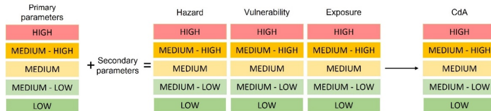
Figure 2 - Logic flow for the CdA determination (Adapted from “Linee guida per la classificazione e gestione del rischio, la valutazione della sicurezza ed il monitoraggio dei ponti esistenti”, Ministero delle Infrastrutture e dei Trasporti (MIT) (2020))
